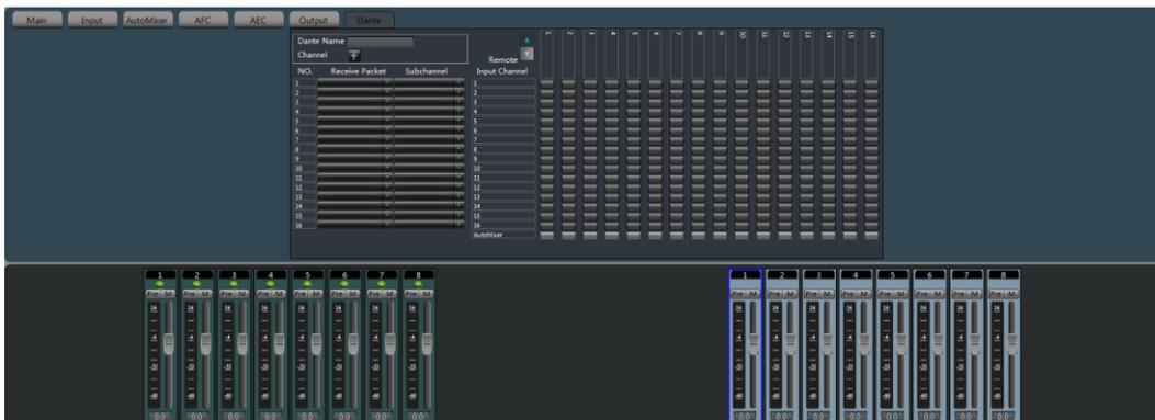
Интерфейс DANTE позволяет подключать устройства, в том числе и сторонних производителей, для обмена аудиоданными (до 16-та каналов).
