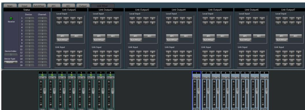
Позволяет объединить в стек (для совместной работы) до 4-х устройств SOLON /EX PLUS. Аудиосигналы могут передаваться между устройствами, объединенными в стек, в произвольном порядке.
