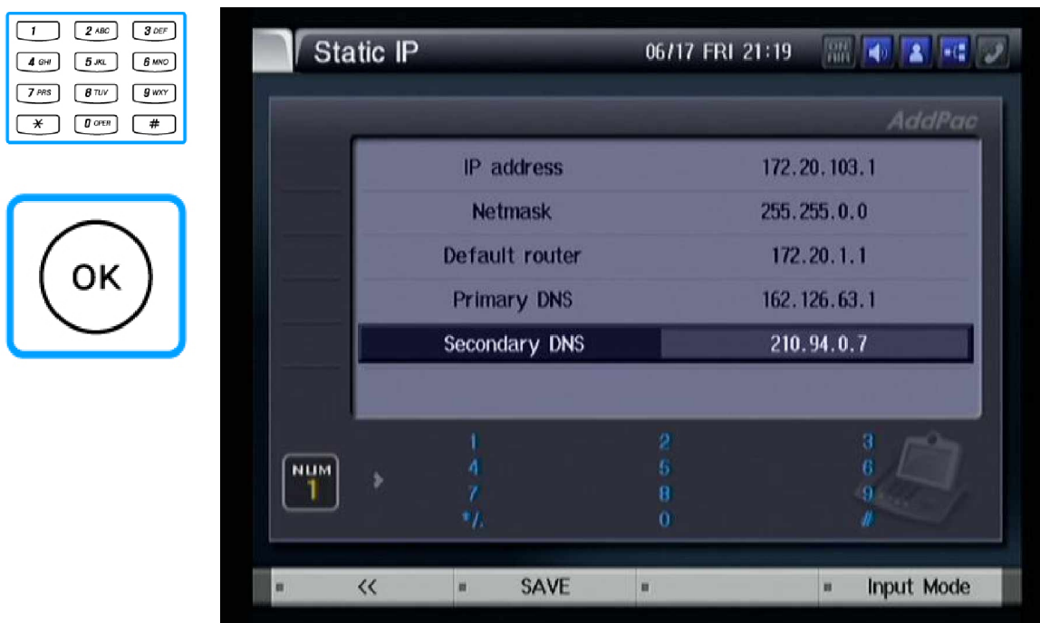
Figure 3-131 В меню "Static IP" в поле "Secondary DNS" введите IP адрес альтернативного DNS сервера (для примера: '210.94.0.7')
