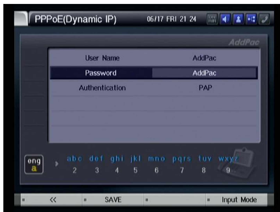
Рисунок 3-137 В меню "PPPoE(DynamicIP)" в поле "Password" введите пароль (например 'AddPac')
