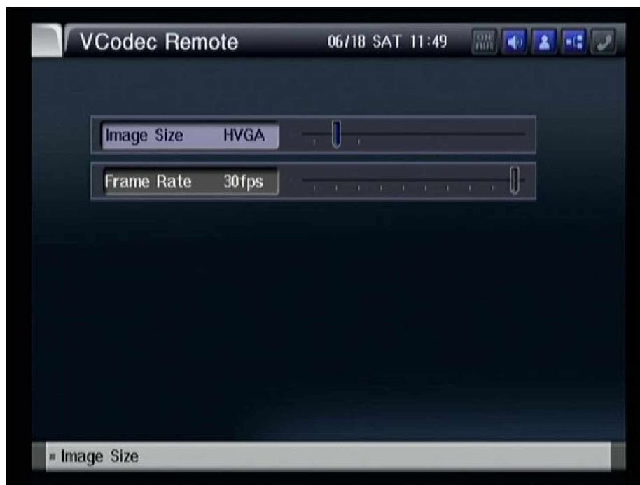
Рисунок 3-170 В поле "Image Size" установите требуемое разрешение
