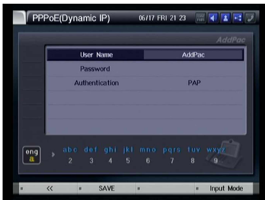
Рисунок 3-136 В меню "PPPoE(DynamicIP)" в поле "User Name" введите имя (например 'AddPac')
