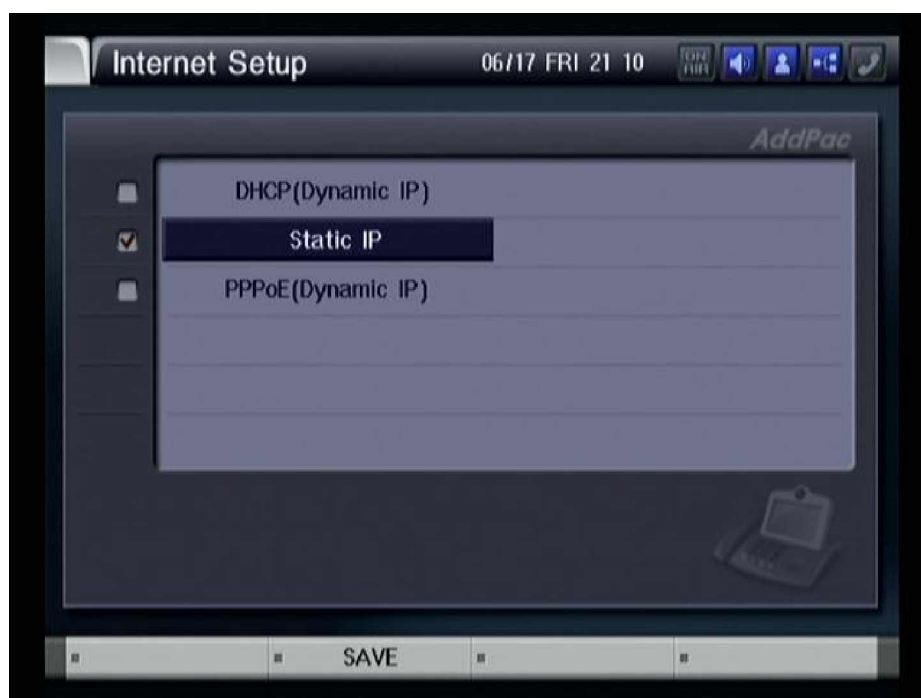
Рисунок 3-126 В меню "Internet Setup" выберете пункт "Static IP"
