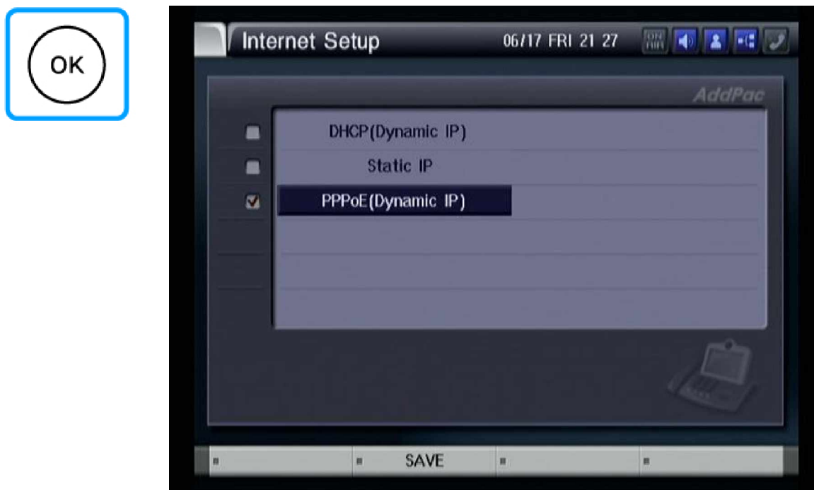
Рисунок 3-139 Для перемещения к предыдущему меню нажмите 'OK', для сохранения – F2
