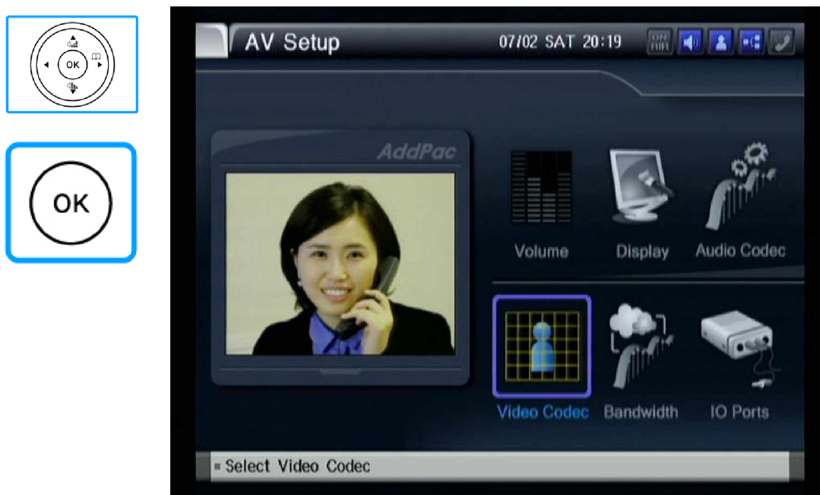
Рисунок 3-102 В меню "AV Setup" выберете пункт "Video Codec"
