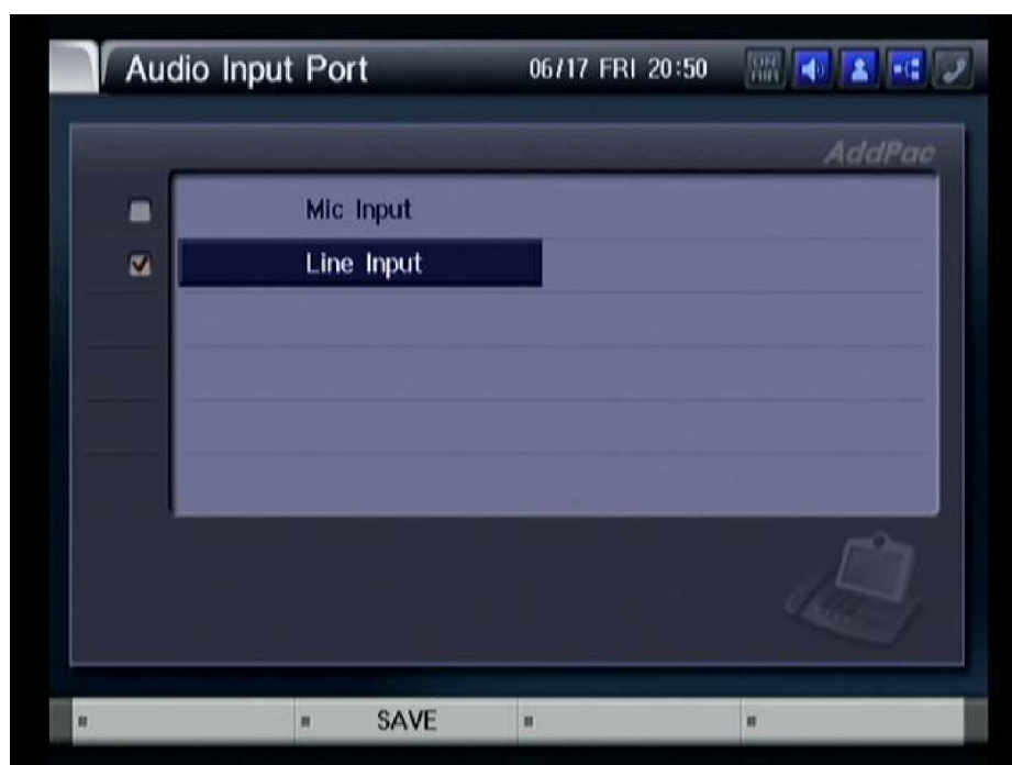
Рисунок 3-116 В меню " Audio Input Port " выберите пункт "Line Input" (сохранение – клавиша F2), для перемещения на предыдущее меню нажмите CANCEL
