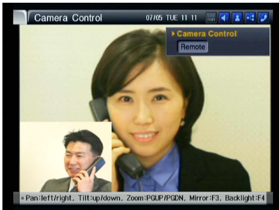
Рисунок 4-16 Пример включения функции "Зеркальное изображение" на удаленной камере
