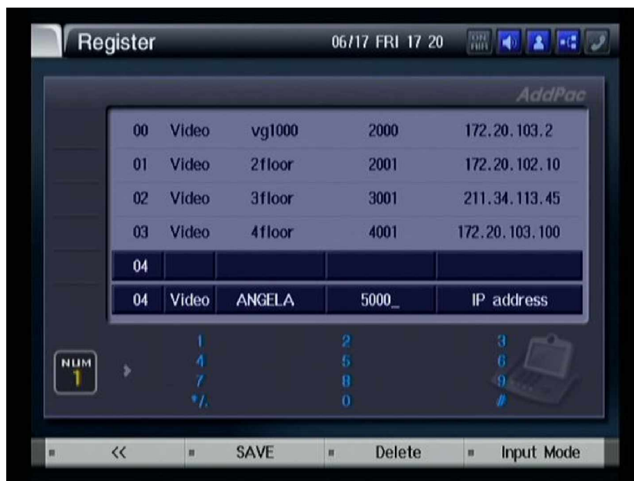
Рисунок 3-42 Пример добавления телефонного номера '5000'
