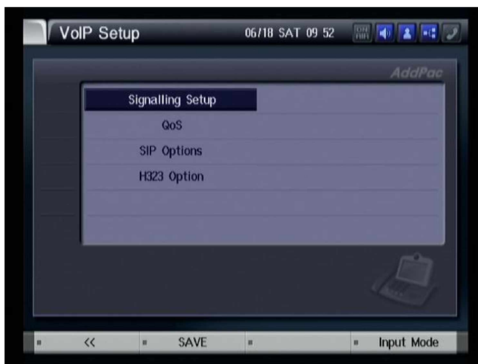
Рисунок 3-141 В меню “VoIP Setup” выберете пункт “Signaling Setup”
