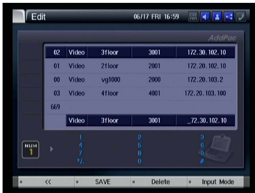
Figure 3-29 Для перемещение в поле IP адрес и редактирования адреса нажмите клавишу указанную на рисунке
