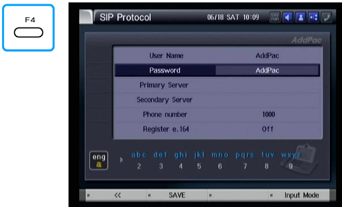
Рисунок 3-145 В поле "Password" введите пароль, для регистрации на SIP сервере
