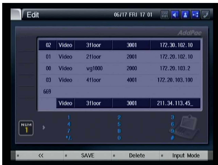
Рисунок 3-30 Изменение IP адреса на '211.34.113.45'
