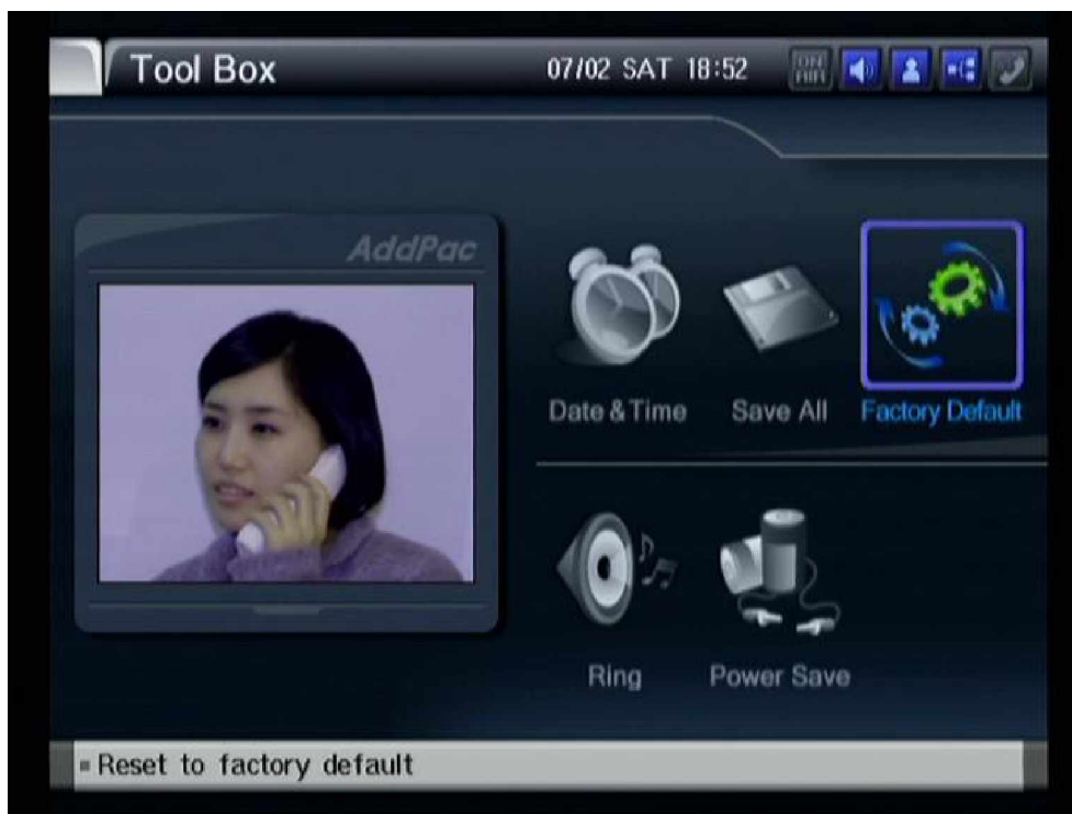
Рисунок 3-65 В меню "Tool Box" выберете пункт "Factory Default"
