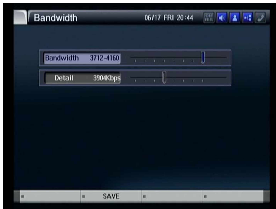
Рисунок 3-110 В пункте "Bandwidth" – производится грубая настройка полосы пропускания
