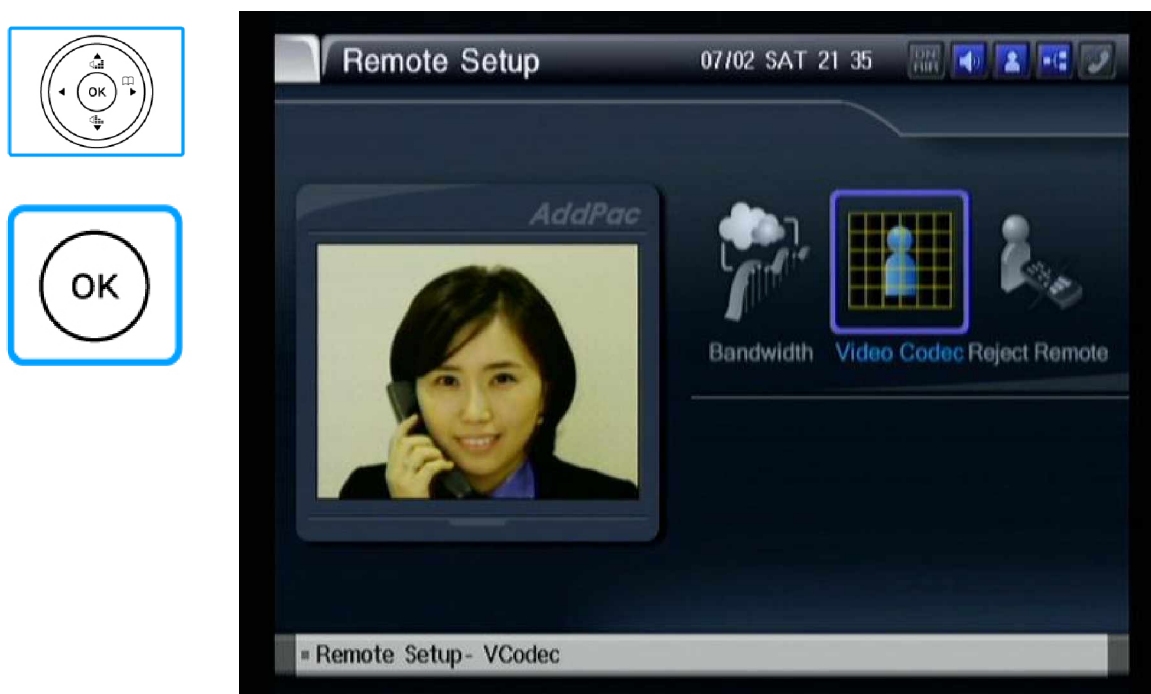
Рисунок 3-169 В меню "Remote Setup" выберите пункт "Video Codec"
