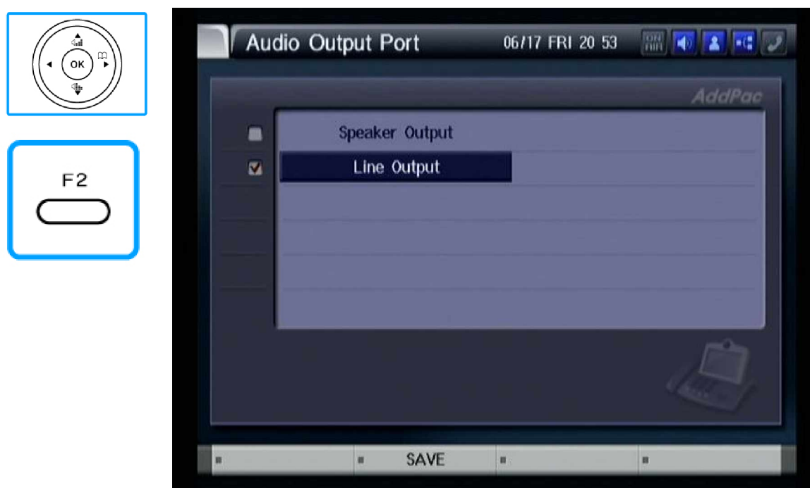
Figure 3-118 В меню "Audio Output Port" выберете пункт "Line Output", сохраните измененные параметры клавишей F2
