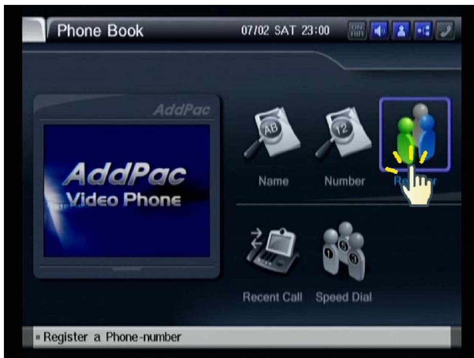
Рисунок 5-7 Для создания новой записи прикоснитесь к иконке "Register"
