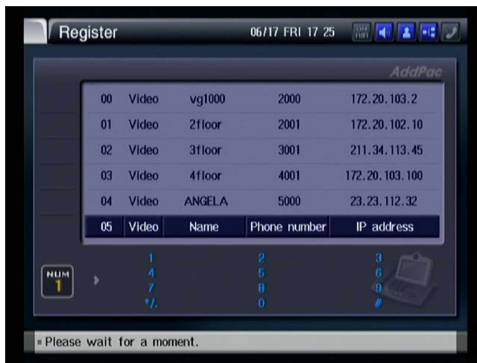
Рисунок 3-45 Для сохранения записи последовательно нажмите клавиши 'OK', 'F2'
