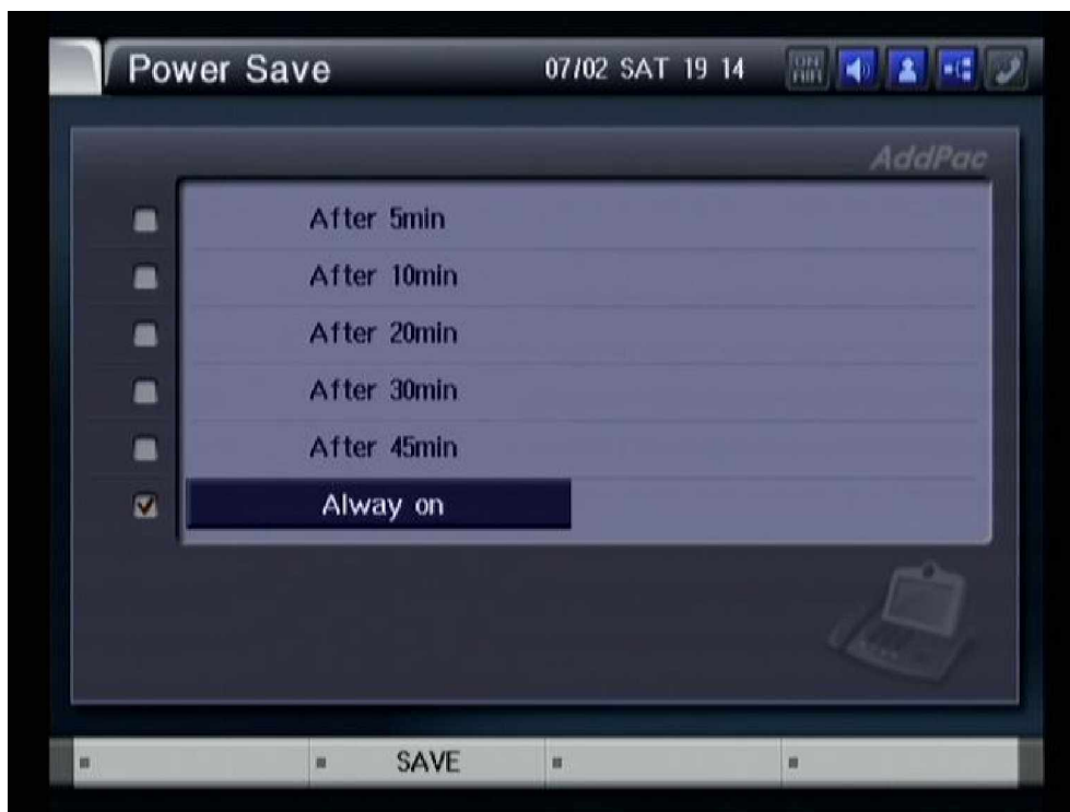
Рисунок 3-69 Выбор времени активации режима “Энергосбережение”
