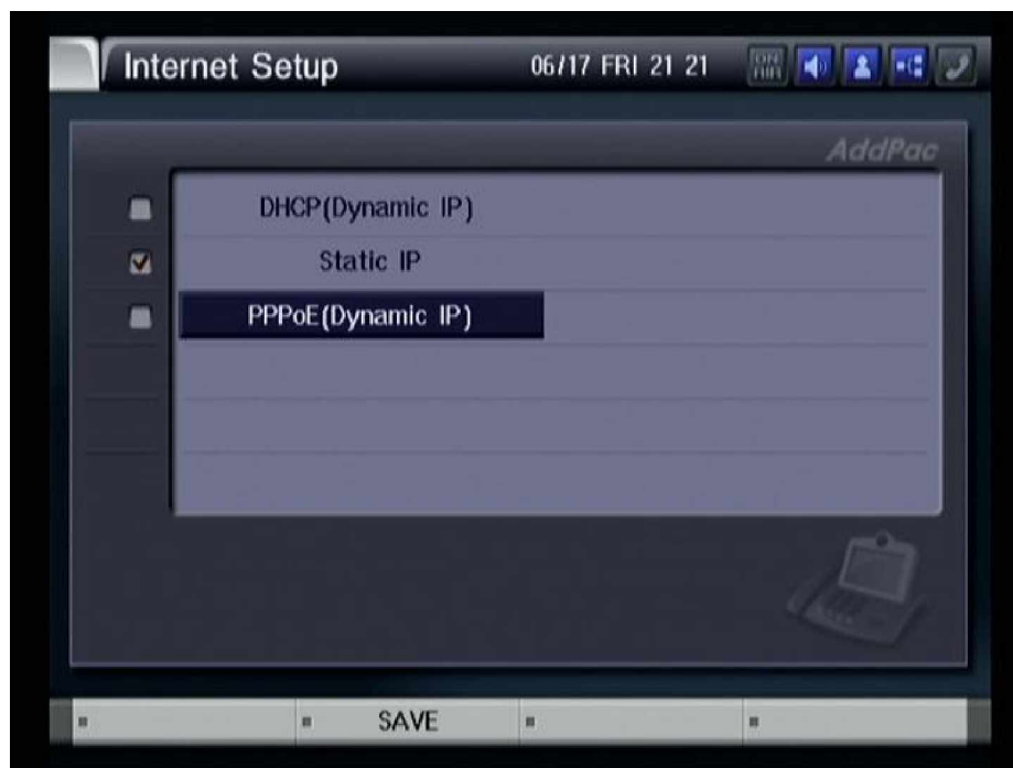
Рисунок 3-135 В меню "Internet Setup" выберите пункт "PPPoE (Dynamic IP)"
