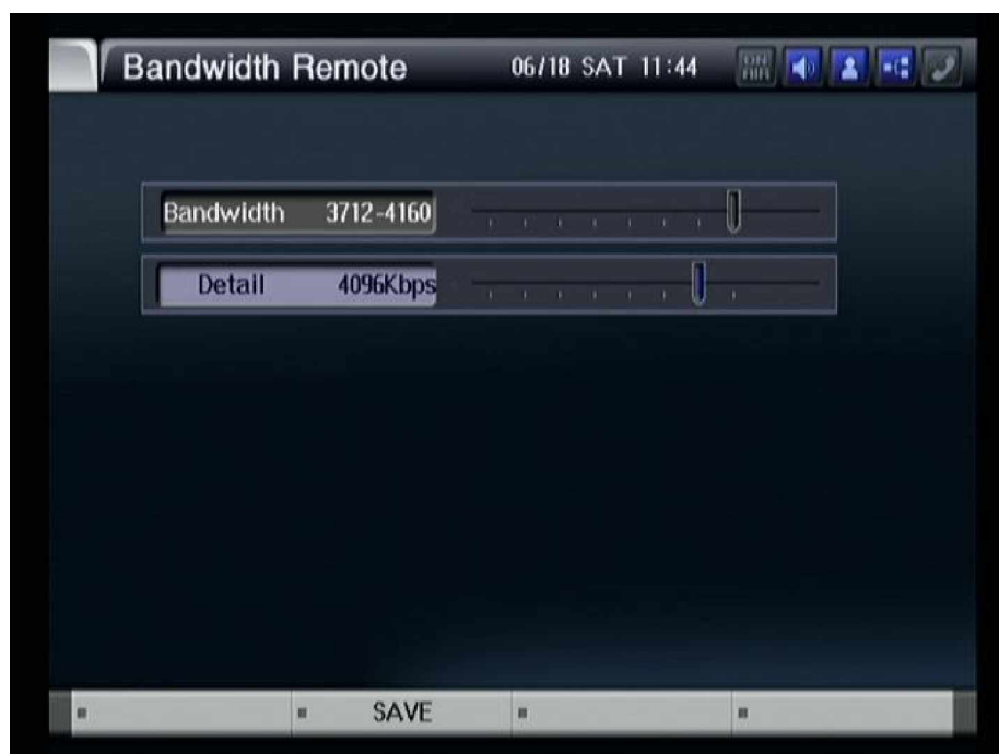
Рисунок 3-166 В меню "Bandwidth Remote" пункт "Detail" – точная настройка полосы пропускания.
