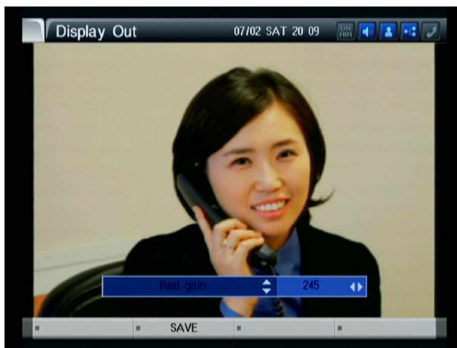
Рисунок 3-94 Настройка уровня красного, Сохранение измененных параметров (клавиша F2)
