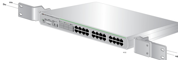
Рисунок 19. Крепление кронштейнов к коммутатору
