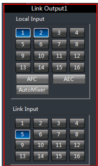
Рис. 4.3 Программирование выходного канала устройства.
