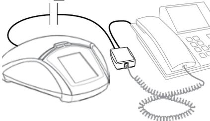
Отсоедините кабель телефонной трубки от корпуса телефона и подсоедините его к телефонному адаптеру, как показано на рисунке ниже.
